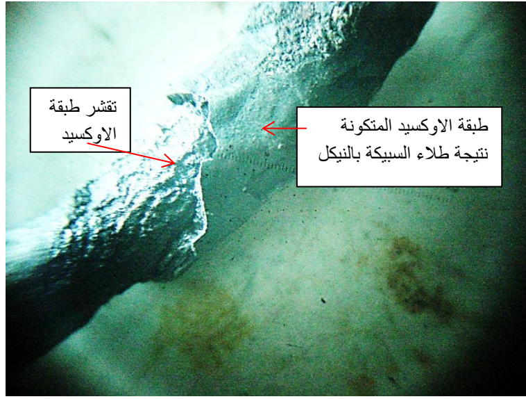
الشكل 4: التركيب المجهرى لأكسدة سبيكة الصلب الطري ( Mild steel AISI 1020 ) المطلية بالنيكل (300X)
